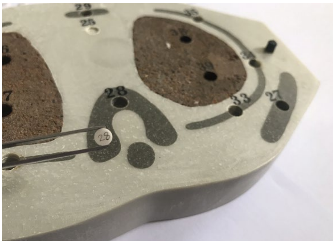
Рисунок 4 – Приклад зарядження фантому детекторами. Детектор, з підписом позиції 28, вкладається в лунку номер 28
